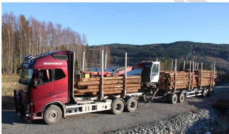
Figur 7: Tømmervogntog med langhenger (4 aksler) lastet etter bruksklasse T8 med 50 tonn totalvekt. (Foto: Dag Skjølaas)
